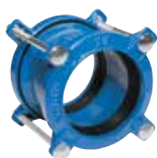
Serie 601 Supa Plus™ universele rechte wide range koppeling voor gietijzeren, stalen, uPVC en asbestcement buizen DN 40-400 PN 16
