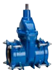
Serie 01/70 Supa Plus™ schuifafsluiter Trekvast voor PE- en uPVC- buizen Nodulair gietijzer DN 40-300 PN 16
