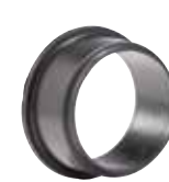
Serie 05 Combi-flensdichting voor uPVC-, stalen of nodulair gietijzeren buizen Niet-trekvast SBR rubber DN 400-600 (uPVC en nodulair) DN 50-300 (staal)
