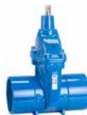
Serie 32/70 Schuifafsluiter met spie-einden voor gietijzeren buizen DN 80-300 PN 16 Nodulair gietijzer
