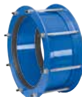
Serie 258 Op maat gemaakte rechte koppeling voor buizen in AC, staal, nodulair gietijzer Staal DN 350-2000 PN 8 to 25
