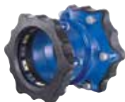
Serie 632 Supa Maxi™ verloopkoppeling Universeel en trekvast Voor alle buistypes Nodulair gietijzer DN 50-300 PN 16
