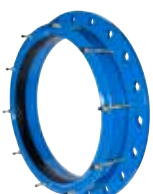
Serie 260 Op maat gemaakte flensadapter voor AC, stalen, gietstalen en nodulair gietijzeren buizen Staal DN 350-2000 PN 10/16/25
