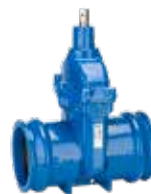
Serie 01/80 Mofafsluiter voor uPVC-buizen DN 40-400 PN 16 Nodulair gietijzer
