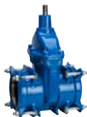
Serie 01/70 Supa Plus™ schuifafsluiter Trekvast koppeling- uiteinden voor PE- en uPVC-buizen DN 40-300 PN 16 Nodulair gietijzer
