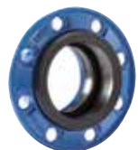
Serie 05 Combi-flens voor PVC-buizen Niet-trekvast Nodulair gietijzer DN 50-300 PN 10/16
