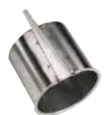
Serie 05 Steunbus voor PE-buizen Geschikt voor Supa Maxi™, Supa Plus™ en Combi-flenzen Roestvast staal DN 50-400 SDR 11 & 17
