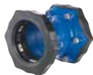
Serie 631 Supa Maxi™ rechte koppeling Universeel en trekvast Voor alle buistypes Nodulair gietijzer DN 50-600 PN 16
