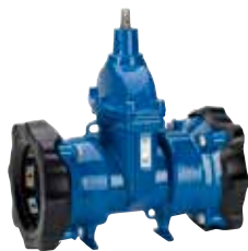
Serie 636/00 Supa Maxi™ Schuifafsluiter Universeel en trekvast voor alle buistypes Nodulair gietijzer DN 80-300 PN 16
