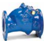
Serie 41/61 Scharnierende terugslagklep Zacht dichtend Gesloten bussen DN 50-300 PN 10/16 Nodulair gietijzer
