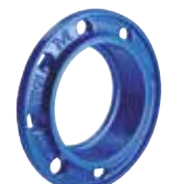
Serie 05 Combi-flens voor uPVC-, stalen of ductile gietijzeren buizen Niet-trekvast Nodulair gietijzer DN 400-600 (uPVC en nodulair) DN 50-300 (staal) PN 10/16
