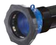
Serie 635 Supa Maxi™ overgangskoppeling met PN 10 of PN 16 buiselind Universeel en trekvast voor alle buistypes Nodulair gietijzer DN 50-300 PN 10/16
