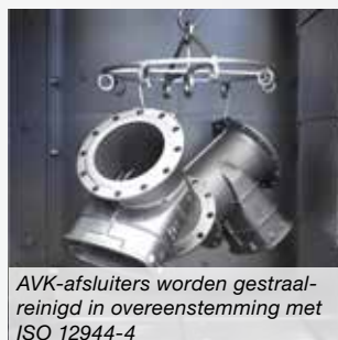
Epoxycoating in overeenstemming met de eisen van DIN 30677-2 en GSK
