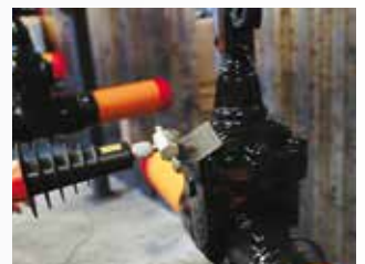
Elke afsluiter wordt getest op perforaties
