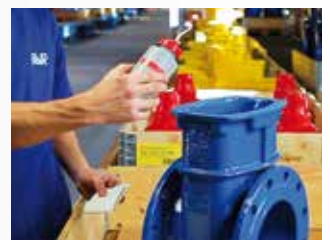
Tijdens de MIB-test mogen er geen kleurvlekken ontstaan
