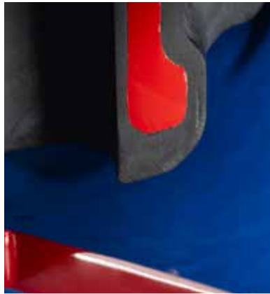
Bij opening krijgt het rubber weer zijn oorspronkelijke vorm
