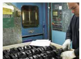
Schuiven worden ge vulkaniseerd tot minstens 4 mm op alle dichtingsoppervlakken
