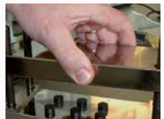
Het rubber vervormt voor 25% tijdens de indruktest
