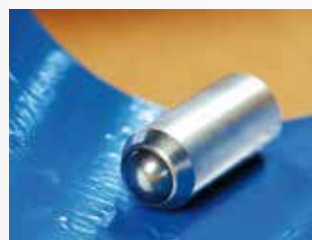
De impactbestendigheid wordt getest met een stalen cilinder
