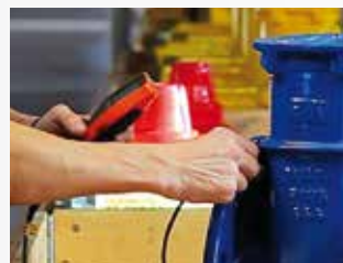
De epoxycoating moet een dikte van minstens 250 \mu hebben op alle oppervlakken
