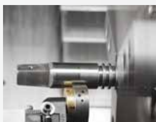
Spindels voor gasafsluiters (3) worden gepolijst om hun dichtheid te garanderen
