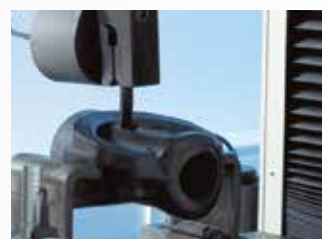
Na de afpeltest moet er een dun rubberlaagje overblijven
