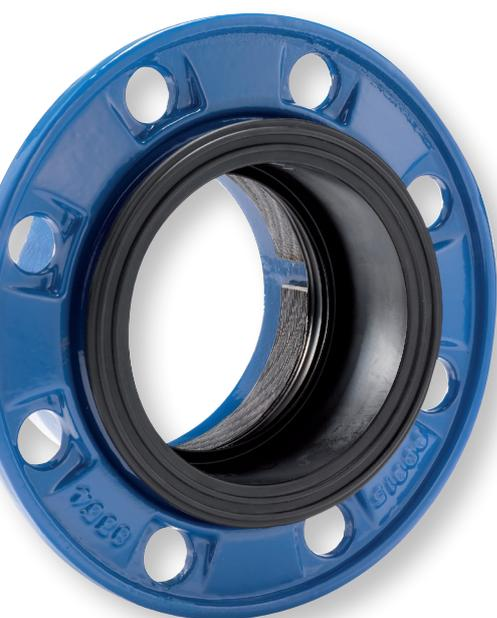
Le système unibrade AVK comprend des brides autobutées pour conduites PE, PVC et fonte ductile de DN 50 à 300 aussi bien que des brides non-autobutées pour PVC, fonte ductile et acier de DN 50 à 600. Les unibrades sont utilisables pour les applications eau potable et eaux usées.
