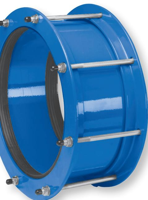
La gamme de raccords sur mesures AVK comprend des manchons non autobutés droits, dissymétriques et adaptateurs à bride de DN 350 à 2000. Cette gamme est adaptée aux conduites en fonte ductile, fonte grise, acier, PVC et GRP pour eau potable et eaux usées jusque 25 bar.
