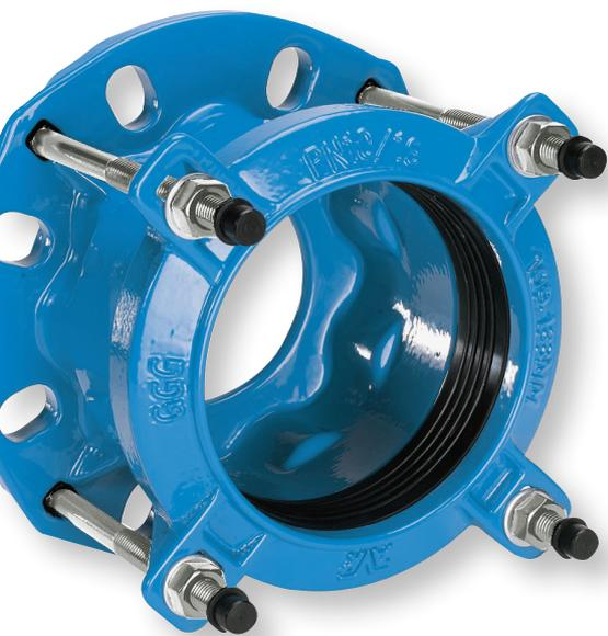
Les manchons droits, dissymétriques et adaptateurs à bride universels Supa® AVK sont adaptés aux tuyauteries PVC, fonte grise, fonte ductile, acier et fibre-ciment. La gamme de DN 40 à 400 convient aux applications en eau potable et eaux usées.
