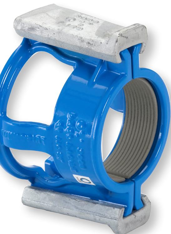
AVK offre aussi une connexion simple, rapide et autobutée entre les tuyaux PVC/PE et une vanne à manchon ou un raccord à emboîtement. Cette prise autobutée est disponible du DN 80 au 200, diamètres extérieurs  $\varnothing 90\text{mm}$ - $\varnothing 225\text{mm}$ . La fonction autobutée de la prise a été testée et approuvée pour une pression de service jusqu'à 20 bar.
