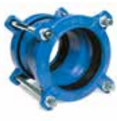
Série 602 Supa® Manchon large tolérance dissymétrique Universel Pour tuyaux en fonte ductile, acier, uPVC et AC Fonte ductile DN 80-250 PN 16
