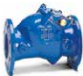
Série 41/61 Clapet à battant Avec caoutchouc Axe fermée DN 50-300 PN 10/16 Fonte ductile
