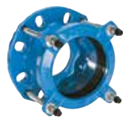
Série 603 Supa® Adaptateur à bride large tolérance Universel Pour tuyaux en fonte ductile, acier, uPVC et AC Fonte ductile DN 40-400 PN 10/16
