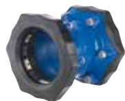
Série 631 Supa Maxi™ Manchon symétrique Autobuté et universel Pour tous types de tuyaux Fonte ductile DN 50-600 PN 16
