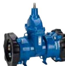
Série 636 Supa Maxi™ Vanne à opercule Autobuté et universel Pour tous types de tuyaux Fonte ductile DN 80-200 PN 16
