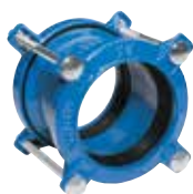
Série 601 Supa® Manchon large tolérance symétrique Universel Pour tuyaux en fonte ductile, acier, uPVC et AC Fonte ductile DN 40-400 PN 16
