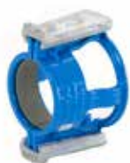
Série 712 Manchon autobuté pour tuyaux en PVC DN 80-200 90-225 mm PN 16
