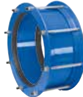
Série 258 Manchon symétrique fabriqué sur demande Pour des tuyaux AC, acier et fonte ductile Acier DN 350-2000 PN 8 à 25
