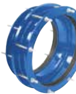
Série 259 Manchon dissymétrique fabriqué sur demande pour des tuyaux AC, acier et fonte ductile Acier DN 350-2000 PN 8 à 25
