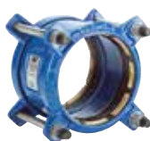
Série 621/10 Supa Plus™ Manchon symétrique Autobuté sur les tuyaux en PE et uPVC Fonte ductile DN 32-300 PN 16
