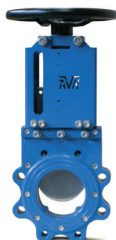
Série 702/10 Vanne à guillotine avec tige non montante et volant Caoutchouc NBR Fonte ductile DN50-1200 AISI 316
