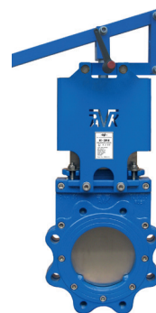
Série 702/30 Vanne à guillotine avec levier Caoutchouc EPDM Fonte ductile DN50-150 AISI 316
