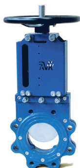
Série 702/20 Vanne à guillotine avec tige montante et volant Caoutchouc NBR Fonte ductile DN50-1200 AISI 316
