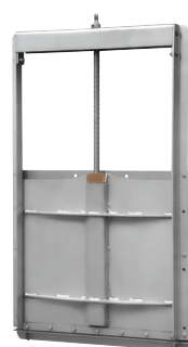
Série 772/61 Vanne murale Étanchéité double jusque 1200 x 1200 mm ; dans des dimensions plus importantes, étanchéité simple ou double face. Avec tige non montante en acier inoxydable AISI 304 200 x 200 - 2000 x 2000 mm Bidirectionnelle
