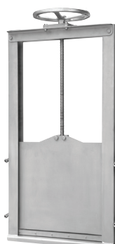
Série 772/61 Vanne batardeau Étanchéité simple face jusque 1000 x 1000 mm ; dans des dimensions plus importantes, étanchéité simple ou double face. Avec tige non montante en acier inoxydable AISI 304 200 x 200 - 2000 x 2000 mm Unidirectionnelle
