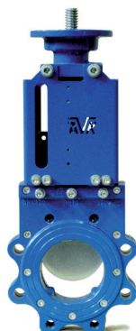
Série 702/50 Vanne à guillotine avec bride ISO pour actionneur Caoutchouc NBR Fonte ductile DN50-1200 AISI 316
